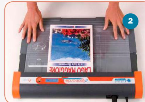
Coloca la funda CoLibri en la ranura y presiona START: e-Leonardo acciona los sensores, desciende, corta y suelda automáticamente.
